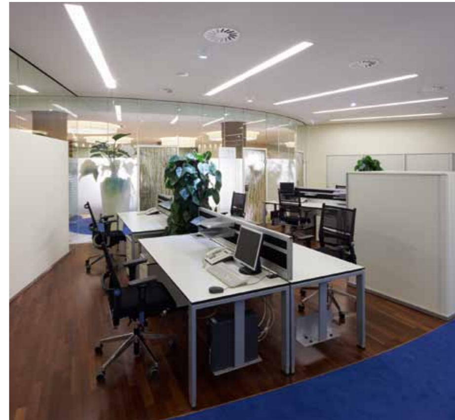
▲ Um die Lautstärke im Großraumbüro niedrig zu halten, wurde auf den Laufwegen Teppichboden verlegt.
